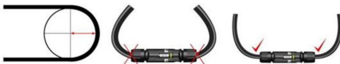
図 6-2 ケーブルの最小曲げ半径
