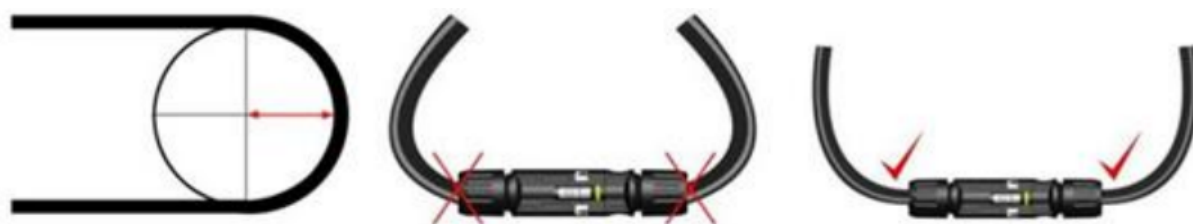
図 6-2 ケーブルの最小曲げ半径
