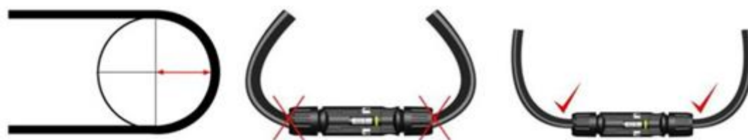
図 6-2 ケーブルの最小曲げ半径
