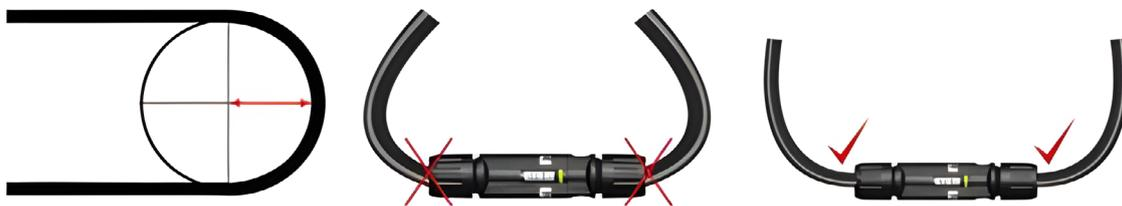
Figura 21. Raio de curvatura mínimo do cabo
