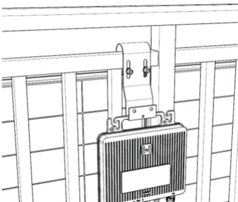
Hängen Sie den Mikrowechselrichter in die untere Halterung des Mikrowechselrichter-Hakens.
