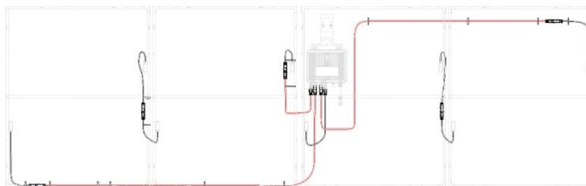
DC-Leitungsverdrahtung für vertikale Montage
