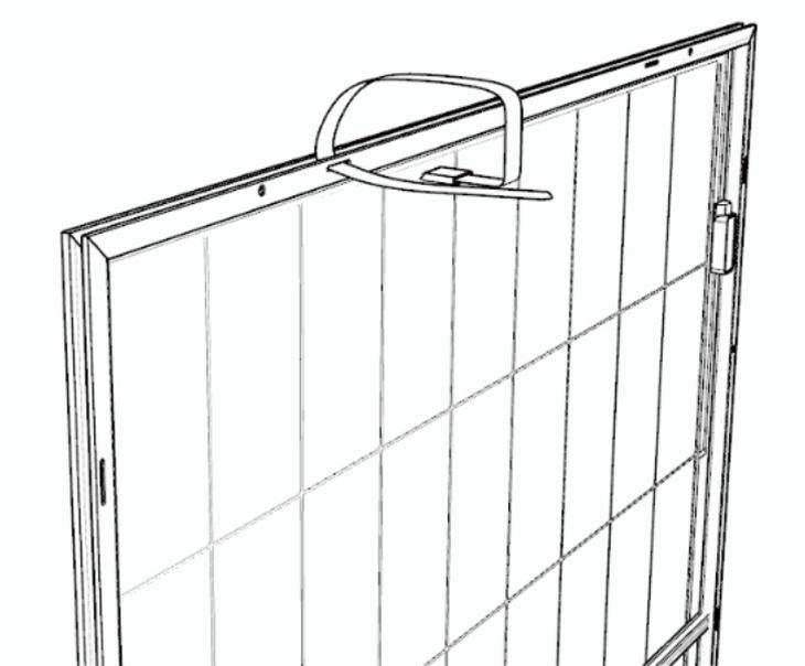
3) Befestigen Sie das flexible Balkon-Photovoltaikmodul mit dem Edelstahlband am Geländer.
