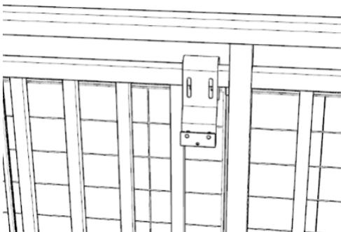
Hängen Sie den Mikrowechselrichter-Haken an das Geländer.
