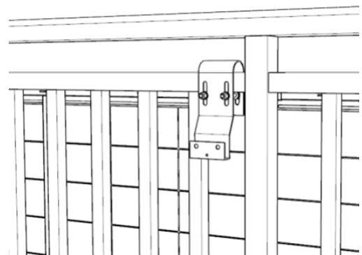
Befestigen Sie den Mikrowechselrichter-Haken mit Schrauben.
