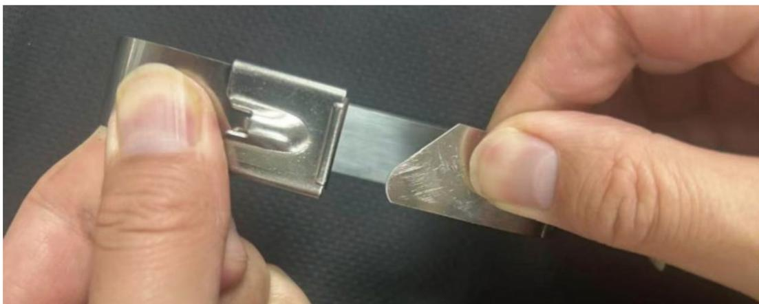
Befestigung mit der Vorderseite nach außen
