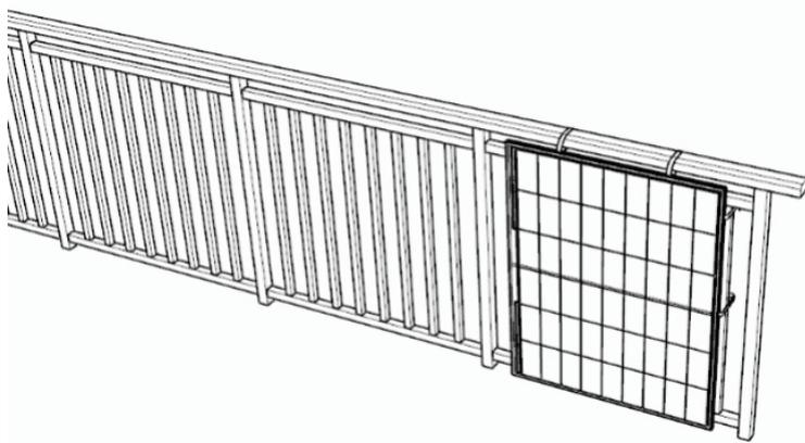
Für Geländer mit einer großen Höhe kann die vertikale Montage gewählt werden (spart Installationsbreite), siehe Abbildung unten.
