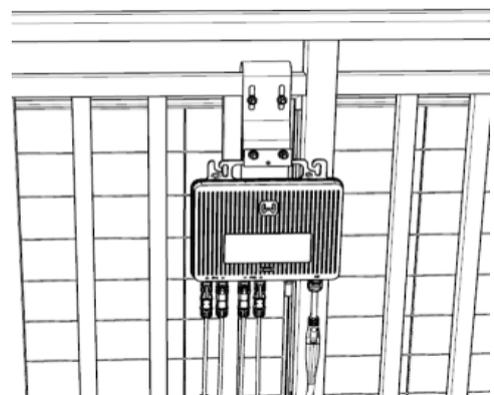
Befestigen Sie den Mikrowechselrichter mit Schrauben.
